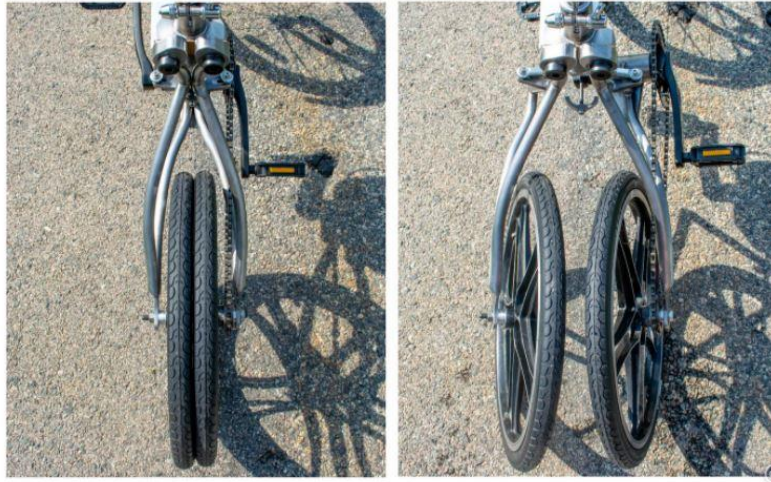
Figure 1.1: MIT Autonomous Bicycle Configurations (Sanchez, 2020)
