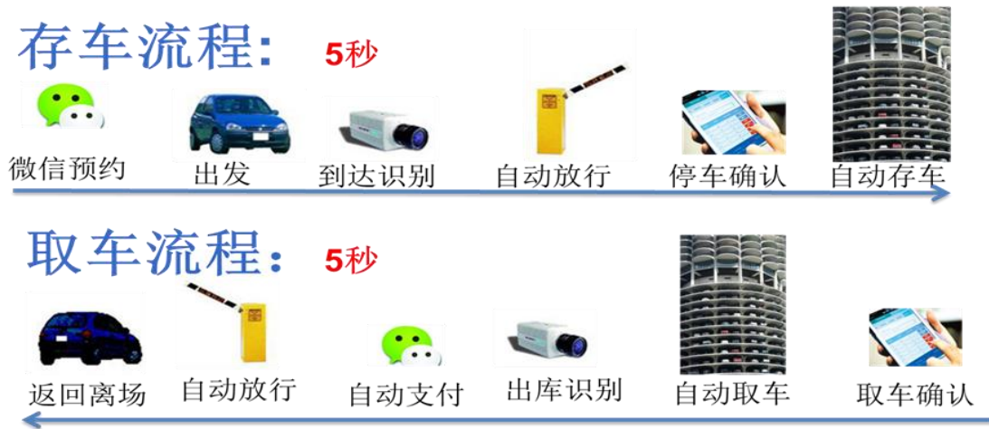
图 3-4 基于无线预约功能的无感支付运营系统图
